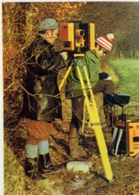
tachéomètre électronique à laser
