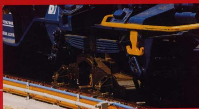
Es un sistema original, patentado por TALGO, para cambiar automáticamente la distancia entre las ruedas de los vehículos ferroviarios al pasar por una instalación fija en la vía, haciendo posible su circulación por redes ferroviarias de distintos anchos. (1000 - 1435 - 1520 - 1668 - ... mm.).
